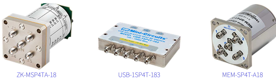
図 1 : SP4T メカニカルスイッチ ZK-MSP4TA-18(左)、SP4T ソリッドステートスイッチ USB-1SP4T-183(中)、MEMS スwitch MEM-1SP4T-18(右)。この中から 1 種類のスイッチのみを使用した設計ですべてのテストニーズを満すことは出来ません。多くの場合、性能、速度、切り替え回数のトレードオフが必要です。
